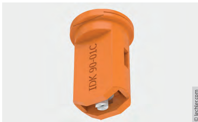
Fig. 133: Buse IDK, Lechler. Exemple de désignation de buse : IDK 90-01C, Buse à injection à jet plat, compacte, avec ouverture en céramique
