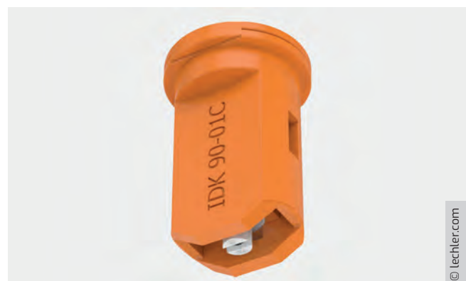
Abb. 133: Düse IDK, Lechler. Beispiele für Düsenkennzeichnung: IDK 90-01C, Flachstrahl-Air-Injektordüse Kompakt mit Keramiköffnung
